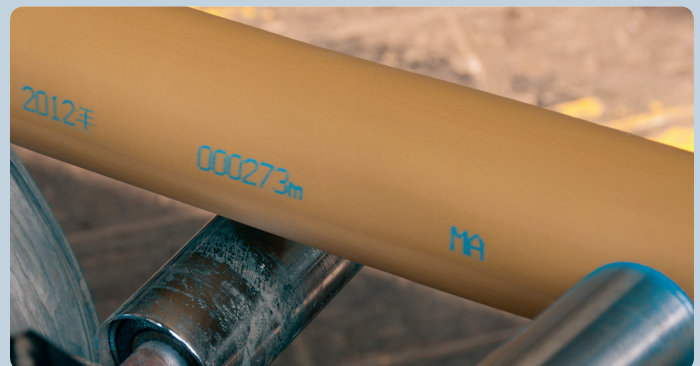
Contrastrijke inkjetcodering op een kabel
